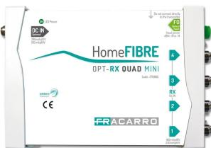
Receptor óptico de TV/SAT que convierte la señal óptica en cuatro salidas universales tradicionales mixtas (SAT+TV+FM). Conector óptico FC/APC. El receptor incluye un latiguillo SC/APC - FC/APC de 50 cm y el adaptador SC/APC.
